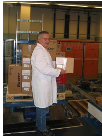
Abbildung 3+4: Umgestaltung eines Verpackungsarbeitsplatzes durch Einbau eines Dreh-Hub-Elementes in die Palettenrollenbahn
